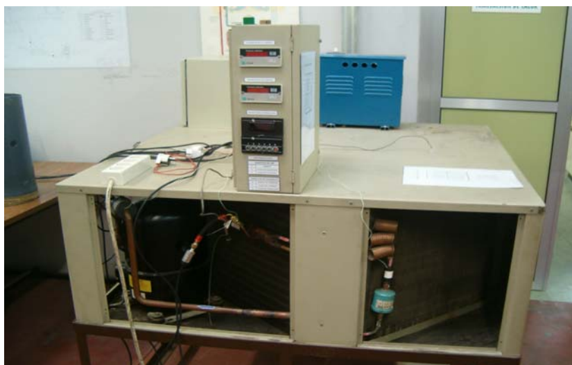
Bomba de Calor aire-aire
