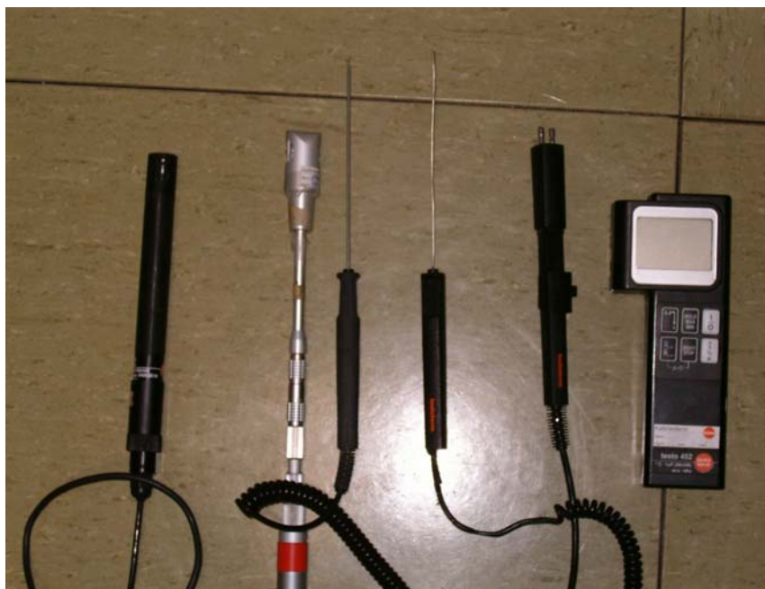
Equipos de medida para auditorias de instalaciones de climatización.
